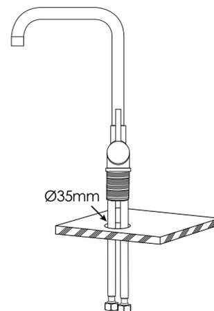
Assurez-vous d'avoir un trou traversant de Ø33mm sur le comptoir. Positionnez et insérez le robinet dans le trou du comptoir prévu à cet effet.
