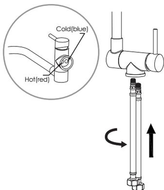
Raccordez manuellement les tuyaux d'alimentation, en veillant à ce que le repère rouge soit aligné sur le tuyau d'eau chaude et le repère bleu sur le tuyau d'eau froide.
