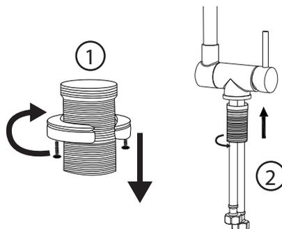
Retirez l'écrou de montage de la tige. Visser la tige sur la base du robinet et la serrer fermement.
