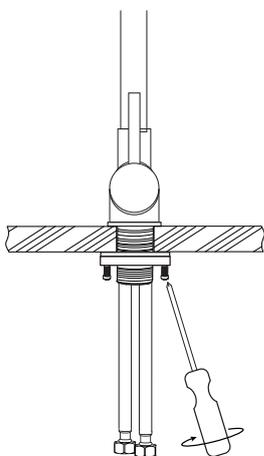
Serrez l'écrou de montage avec les vis jusqu'à ce que le robinet soit fermement fixé.
