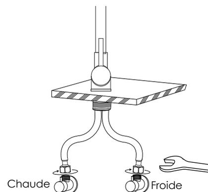
Raccordez les conduites d'eau chaude et froide au tuyau d'entrée et serrez-les fermement à l'aide d'une clé. Ne pas trop serrer.
