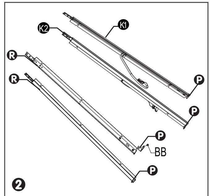
**3** Insérer les goupilles de la base dans les trous du support inférieur. Appuyer pour fixer les goupilles. S'assurer que les 2 supports inférieurs **K1**, **K2** avec la sangle se trouvent du côté des roues. Il est conseillé d'assembler d'abord les deux lignes diagonales du support inférieur et d'utiliser 2 Vis en acier inoxydable M5x10 (**EE**) pour les fixer. Répéter deux fois pour le support inférieur supplémentaire.
