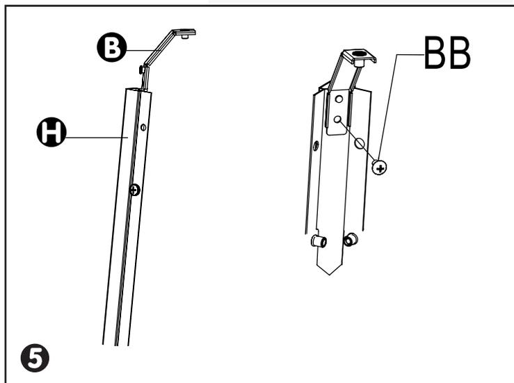
**6** Fixer les 4 supports supérieurs **H** dans la plaque de connexion des supports inférieurs. Fixez-les avec 8 vis M5x10 (**BB**).
