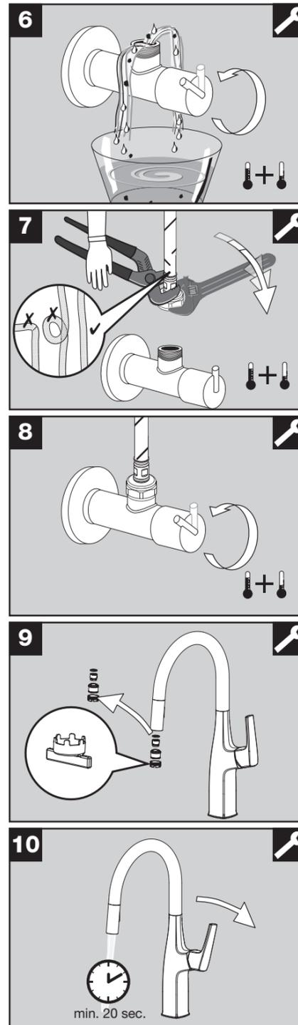
Avant de raccorder les conduites d'alimentation d'eau aux valves, purger les valves afin d'éliminer la poussière et les particules qui pourraient affecter le fonctionnement du robinet, ce qui n'est pas couvert par la garantie.
