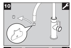
Retirer l'aérateur (5) à l'aide de la clé d'aérateur (6).
