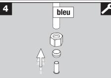
Pousser l'écrou et l'anneau sur le tuyau bleu, puis poussez l'œillet dans le tuyau.
