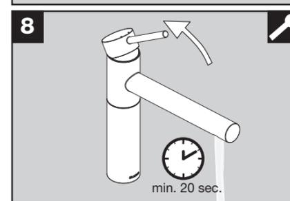
Ouvrir le soupape d'eau et rincer pendant au moins 20 secondes les conduites et le robinet.
