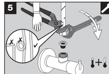
Raccorder la conduite d'alimentation rouge au valve d'eau chaude et la conduite d'alimentation bleue au valve d'eau froide.
