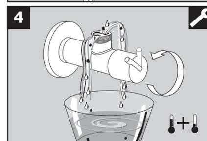
Avant de raccorder les conduites d'alimentation d'eau aux valves, purger les valves afin d'éliminer la poussière et les particules qui pourraient affecter le fonctionnement du robinet, ce qui n'est pas couvert par la garantie.
