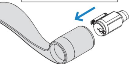
2. Insérez la clé dans le barillet. Le barillet sera maintenu dans le levier par la clé.
