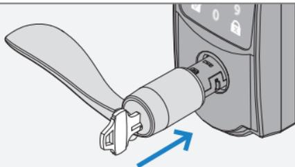
Après l'installation, faites pivoter la clé de 90 degrés dans le sens contraire des aiguilles d'une montre pour l'enlever, et mettez-la dans un endroit sûr.
