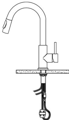
Fixer le poids sur le point vertical le plus bas du côté du tuyau extensible. (pas du côté de la connexion rapide).
