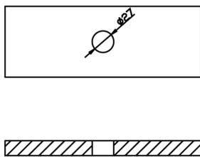
La taille recommandée du diamètre du trou va de 27 mm à 35 mm.
