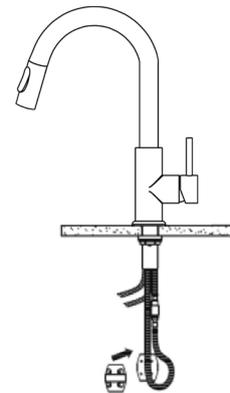
Raccordez le tuyau flexible au raccord rapide et insérez le poids (installation libre)
