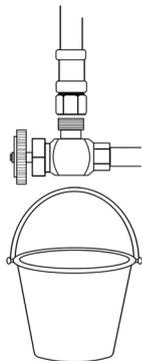
Avant de brancher le tuyau d'alimentation, rincez les vannes d'alimentation pour éliminer tout débris. Placez un seau sous les vannes et faites couler l'eau pendant 5 à 10 secondes. Coupez l'eau.
