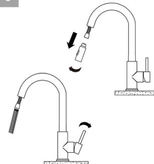
Dévisser la tête de pulvérisation à la main. Maintenez l'extrémité du tuyau de pulvérisation enfoncée, ouvrez le robinet et laissez couler l'eau pendant 60 secondes pour rincer tout débris, puis rebranchez la tête de pulvérisation. Assurez-vous de la présence d'un joint d'étanchéité.
