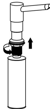
Séparez le réservoir du robinet et enlevez également l'écrou hexagonal.
