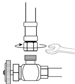
Raccordez les conduites d'eau chaude et froide au tuyau d'entrée et serrez-les bien à l'aide d'une clé. Ne pas trop serrer.
