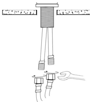
Raccordez les tuyaux d'alimentation tressés au robinet et serrez doucement à l'aide d'une clé.
