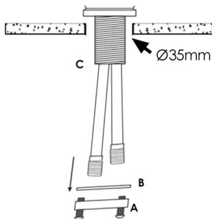
Assurez-vous d'avoir un trou traversant de Ø35mm de diamètre sur le comptoir de la cuisine. Retirez l'écrou de fixation (A) et la rondelle (B) de l'enveloppe fileté (C).
