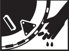
**(EN) AMPUTATION HAZARD.** High speed rotation impeller! To avoid serious injury, please keep hands out of the discharge area during operation. **(FR) RISQUE D'AMPUTATION.** Rotation de turbine à grande vitesse ! Pour éviter des blessures graves, veuillez garder les mains hors de zone de décharge quand le souffleur est en fonction.
