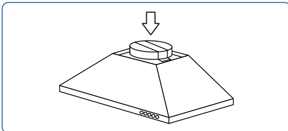
22. Assurez-vous que le registre est correctement installé. Fixez les volets d'aération dans l'orifice d'évacuation sur le dessus de la hotte. Assurez-vous que les volets peuvent s'ouvrir en douceur et sans aucune obstruction. Veuillez noter que les bosses sur les rabats doivent être orientées vers le haut et vers l'extérieur.
