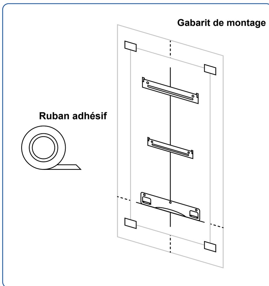
Si vous utilisez la hotte pour déterminer l'emplacement du support de montage sur le mur, trouvez les trous de montage à l'arrière de la hotte.
