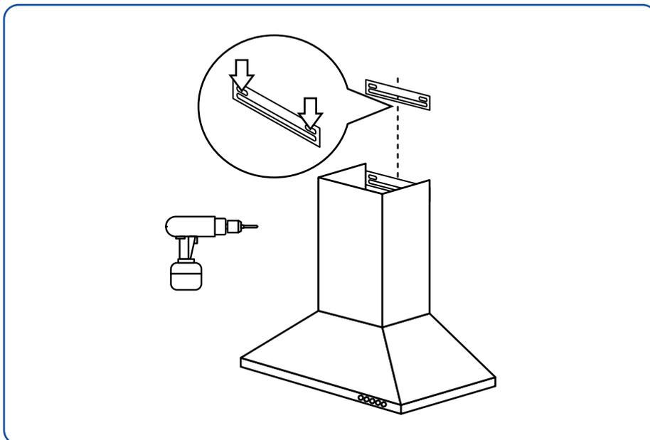
15. En cas de montage directement sur un montant en bois, utilisez les (2) vis de montage ST 4x 30 fournies pour fixer le support de montage en place en perçant (2) trous pilotes.
