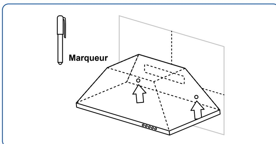
17. Utilisez une perceuse pour faire deux trous dans le mur aux emplacements marqués. Pour le bois, utilisez une mèche de 5/32" , et pour les ancrages muraux, utilisez une mèche de 5/16".
