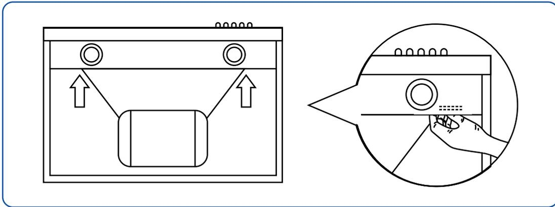
4. Les fils des lumières LED sont connectés à l'aide d'un connecteur encliquetable. Pour déconnecter les lumières LED, appuyez sur le connecteur et tirez doucement le fil électrique opposé loin du connecteur.
