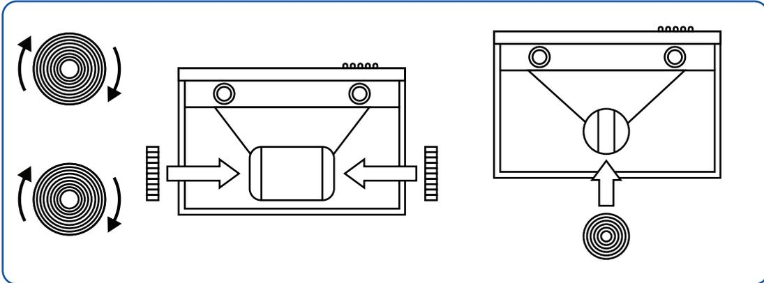
4. Pour remplacer le filtre, tournez-le dans le sens inverse des aiguilles d'une montre puis retirez-le. Après cela, installez le nouveau filtre à charbon et tournez-le dans le sens des aiguilles d'une montre pour le verrouiller en place.
