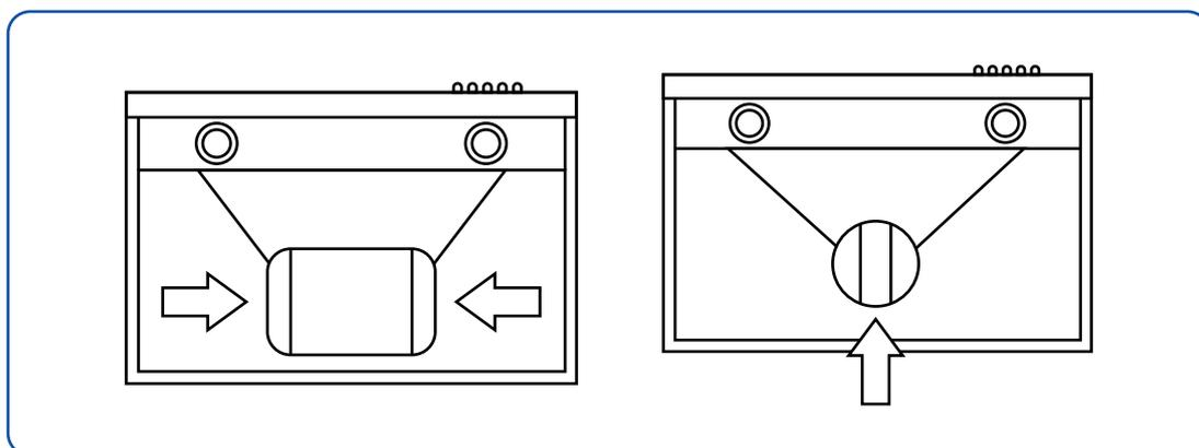
3. Prenez un filtre et fixez-le au moteur. Tournez-le et tournez-le dans le sens des aiguilles d'une montre jusqu'à ce qu'il se verrouille en place. Si votre modèle de hotte nécessite l'installation de deux filtres, les filtres doivent être installés de chaque côté. Répétez l'étape précédente en prenant un autre filtre à charbon et en le fixant de l'autre côté du moteur. Tournez-le et tournez-le dans le sens des aiguilles d'une montre jusqu'à ce qu'il se verrouille en place.
