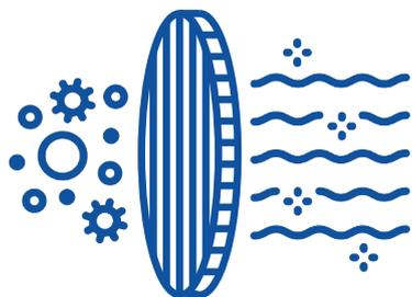
Ces derniers piègent les odeurs présentes dans le flux d'air qui les traverse. L'air est purifié en passant plusieurs fois à travers les filtres puis recirculé dans la cuisine. Les filtres à charbon ne peuvent pas être nettoyés et doivent être remplacés en moyenne tous les 3-4 mois (selon l'utilisation).
