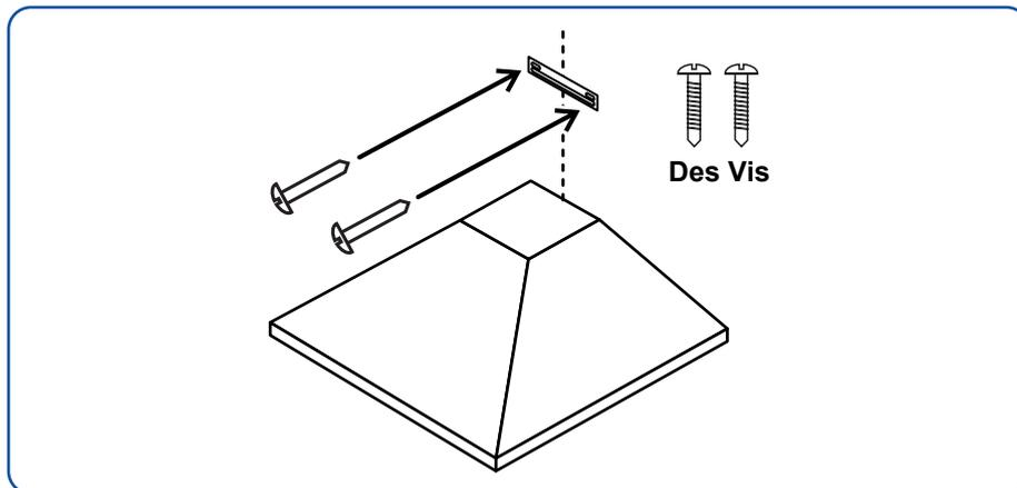
9. En cas de montage au mur, utilisez les (2) chevilles fournies avant d'installer les (2) vis de montage ST 4x30. Insérez fermement les ancrages muraux en plastique dans les trous percés.
