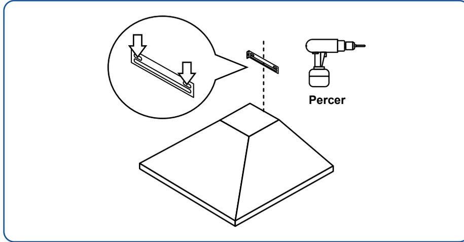
8. En cas de montage directement sur un montant en bois, utilisez les (2) vis de montage ST 4x 30 fournies pour fixer le support de montage en place en perçant (2) trous pilotes.
