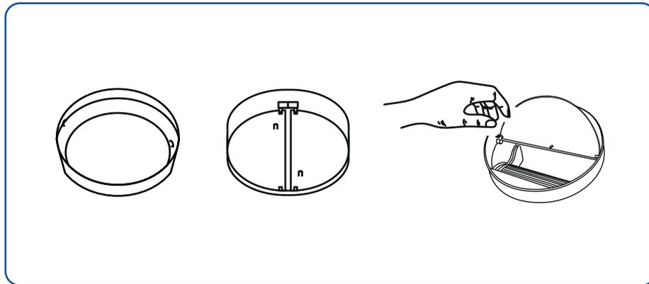
23. Fixez un tuyau d'échappement rond en aluminium de 6 pouces au volet d'aération rond et fixez-le avec deux petites vis, ainsi que du ruban adhésif ou un collier de serrage avec du ruban adhésif.
