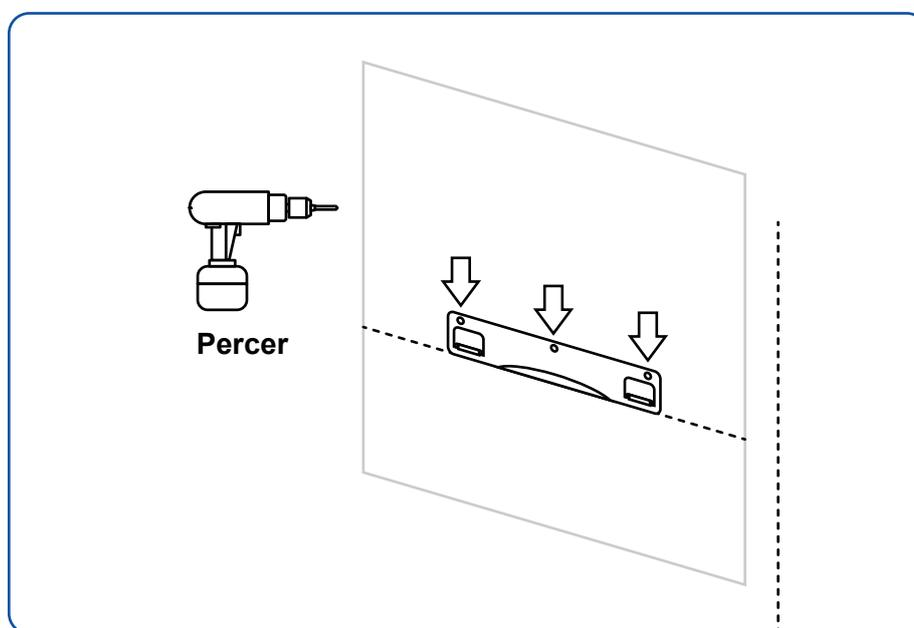
12. En cas de montage directement sur un montant en bois, utilisez les (3) vis de montage ST 4x30 fournies pour fixer le support de montage en place en perçant (3) trous pilotes.
