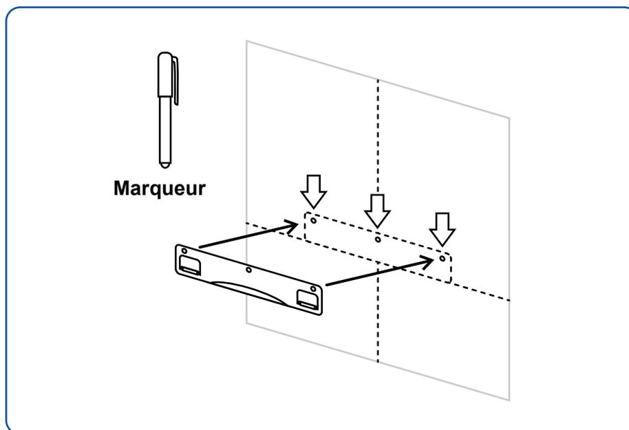
11. Utilisez une perceuse pour faire trois trous dans le mur aux emplacements marqués. Pour le bois, utilisez une mèche de 5/32" , et pour les ancrages muraux, utilisez une mèche de 5/16".
