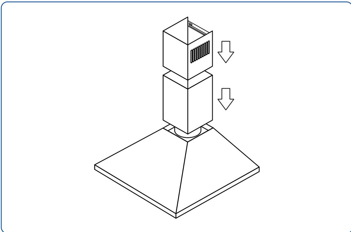
17. Pour fixer la cheminée supérieure, soulevez-la sur le support supérieur et utilisez une vis ST 4x10 de chaque côté de la cheminée pour la fixer en place.
