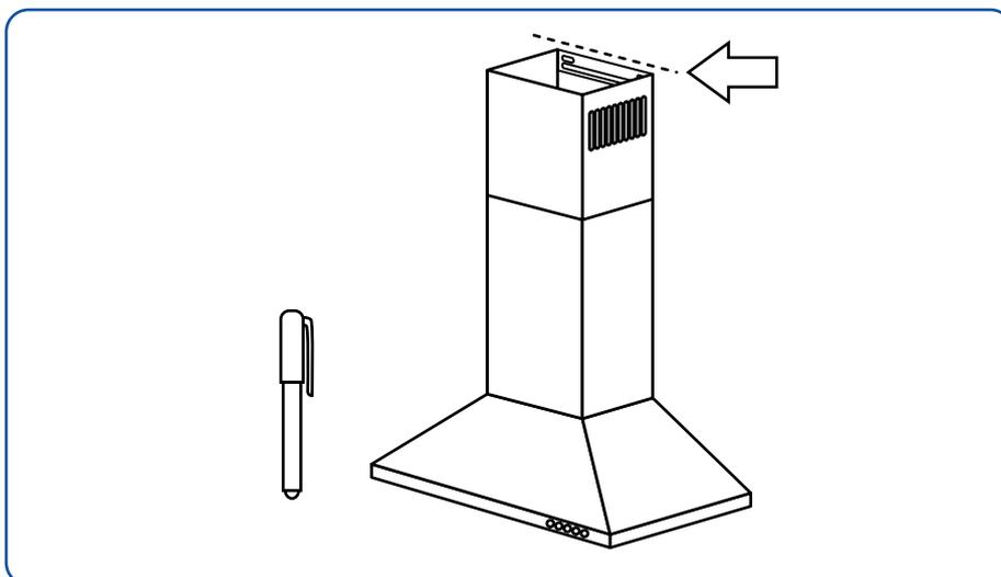
**Lors de la ventilation à travers le mur, veuillez noter qu'il n'est PAS nécessaire que la cheminée entre en contact avec le plafond.**
