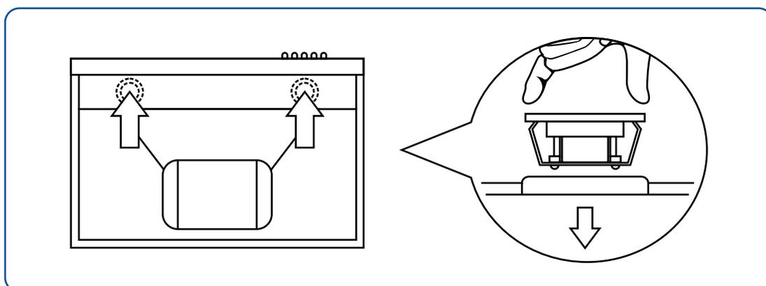
7. Rebranchez le câblage électrique dans la hotte avec le connecteur à pression DEL.
