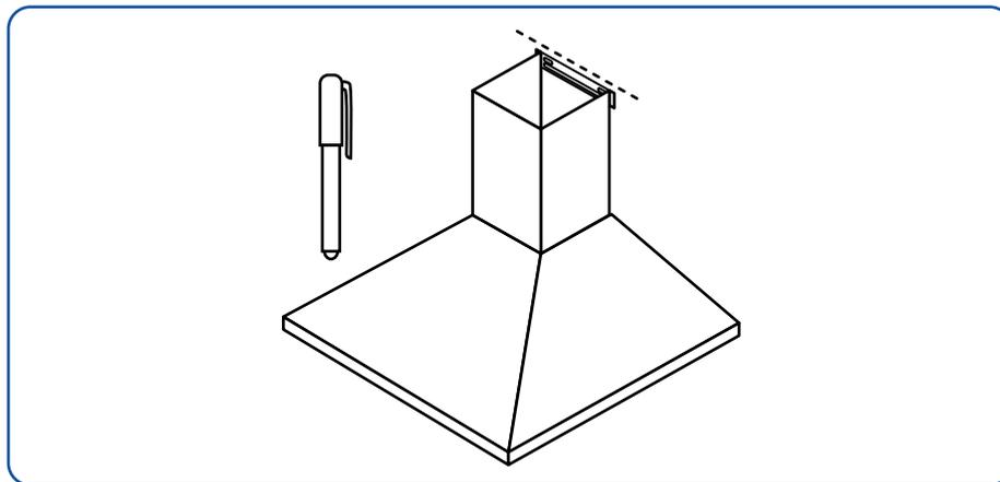
6. Positionnez le support de montage inférieur de la cheminée contre l'endroit marqué et marquez le centre des 2 emplacements de vis de montage sur le mur.
