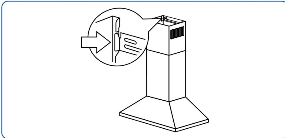
19. Certains modèles de hotte de cuisine peuvent être équipés de trous de vis au bas de la cheminée inférieure. Utilisez (2) [1 de chaque côté] vis 4x10 mm pour serrer et fixer.
