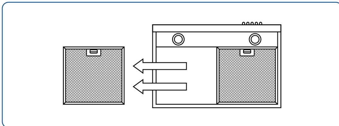
2. L'emplacement du filtre à charbon varie selon le modèle. Dans certains modèles qui ne nécessitent qu'un seul filtre à charbon, l'ouverture se trouve au milieu du moteur. Pour les modèles nécessitant 2 filtres à charbon, les ouvertures sont positionnées sur les côtés du moteur. Si vous avez des questions concernant le modèle spécifique que vous avez acheté, n'hésitez pas à contacter notre équipe d'assistance.
