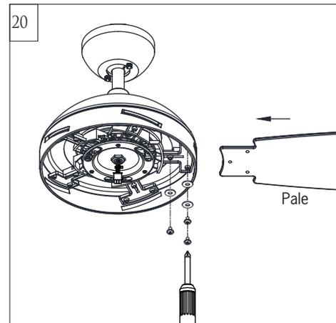
Insérez la pale dans la fente sur le volant d'inertie. Installez la pale avec les vis et les rondelles de fibre fournies, en alignant chacun des trous comme illustré et serrez bien toutes les vis. Répétez ce processus pour les pales restantes.
