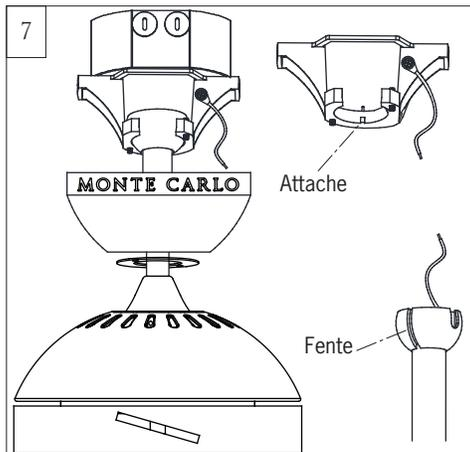
Installez l'extrémité de la bille de la tige d'extension dans l'ouverture du support de montage. Alignez la fente sur la bille avec onglet sur le support de montage.
