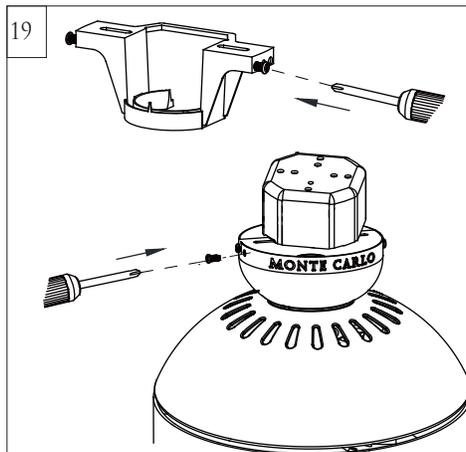
Installez 2 des vis au panneau latéral correspondant aux trous à fentes ouverts sur le rebord supérieur de l'auvent. Les vis sont fournies avec l'ensemble. Retirez tous les goujons filetés de la partie inférieure du support de montage.
