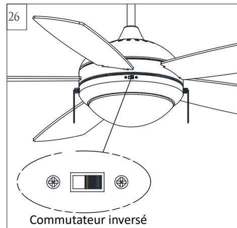
Régler le commutateur inversé du côté de la main gauche aboutira en un flux d'air vers le bas, tandis que régler le commutateur du côté de la main droite aboutira en un flux d'air vers le haut. **Remarque:** Le commutateur inversé doit être configuré d'une manière ou l'autre. Si le commutateur inversé est réglé à la position du centre, le ventilateur ne fonctionnera pas.
