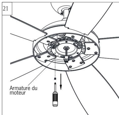
Desserrez 2 vis et retirez 1 vis préassemblée de la plaque sur le moteur. Conservez la vis pour utilisation ultérieure.
