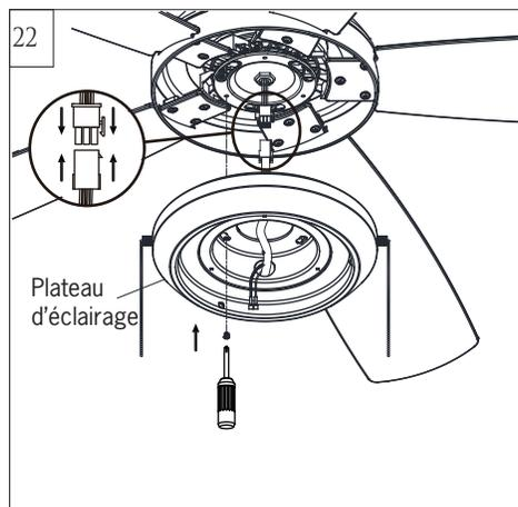
Branchez le connecteur rapide du ventilateur au connecteur rapide du boîtier du commutateur (luminaire) Assurez-vous qu'ils sont fermement pincés ensemble. Placez le luminaire sur les fils et fixez-le sur la plaque du moteur en alignant les fentes de trous sur le luminaire avec les vis préassemblées sur la plaque. Tournez dans le sens horaire jusqu'à ce que l'ensemble se verrouille en place. Réinstallez les vis enlevées à l'étape 21. Serrez bien toutes les vis.
