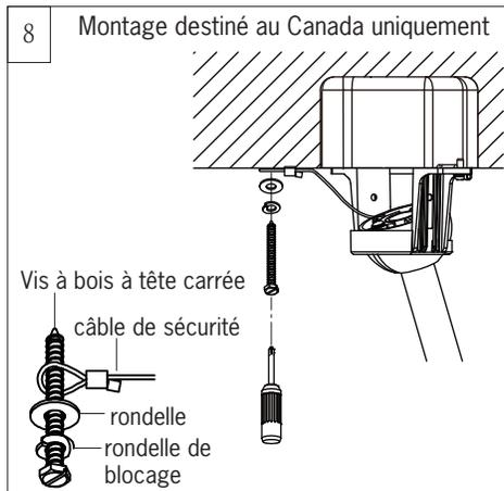
Pour le montage destiné au Canada, que ce soit selon la méthode de suspension encastrée ou selon la méthode de la tige verticale, le câble de sécurité doit être installé dans les poutres de la charpente du bâtiment à l'aide des vis à bois à tête carrée de 7,62 cm fournies à cet effet. Assurez-vous que lorsque le câble de sécurité est entièrement déplié, les fils de connexion sont plus longs que le câble et qu'ils ne sont soumis à aucun effort de tension.
