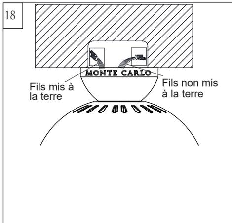
Après avoir établi les liaisons électriques, vous devez étaler les fils en mettant le conducteur mis à la masse et le conducteur de mise à la terre de l'appareillage d'un côté du boîtier de sortie de courant et le conducteur non mis à la terre de l'autre côté de la boîte de sortie de courant.
