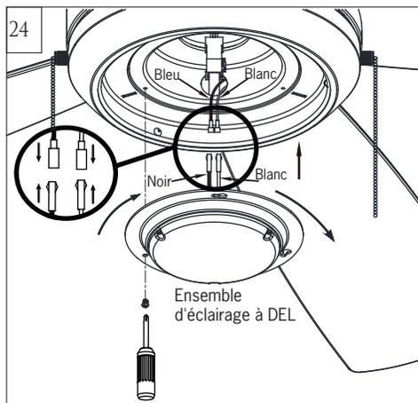
Branchez le fil blanc du ventilateur au fil blanc du luminaire à DEL, puis branchez le fil bleu (ou noir) du ventilateur au fil noir (ou bleu) du luminaire à DEL. Fixez le luminaire à DEL au panneau d'éclairage, en alignant les fentes de la serrure sur le luminaire à DEL avec les vis préassemblées sur le panneau d'éclairage. Tournez dans le sens horaire jusqu'à emboîtement complet. Réinstallez la vis retirée à l'étape 23. Serrez bien toutes les vis.
