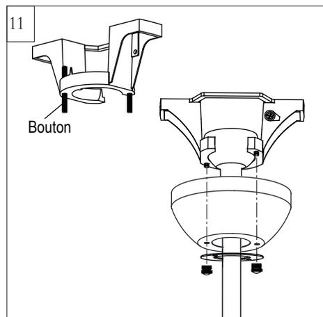
Soulevez l'auvent permettant aux 2 goujons de dépasser de l'auvent. Ensuite, soulevez l'anneau du couvercle et installez les écrous moletés comme montrés. Serrez fermement les écrous moletés. L'auvent doit se régler pour toute irrégularité dans le plafond ou la boîte de sortie. Assurez-vous que les goujons dépassant du bas du support de montage soient installés avec les filets au complet à travers le support.
