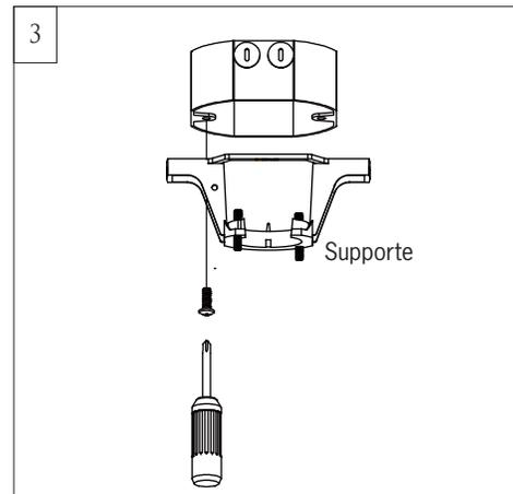
Utilisez la boîte de sortie de courant en métal pouvant supporter le poids du ventilateur (35lbs./16kg.). Avant de relier le ventilateur à la boîte de sortie de courant, assurez-vous que celle-ci est parfaitement attachée au moins en deux points à une pièce de charpente du plafond (une boîte de sortie de courant mal attachée provoquera des secousses du ventilateur). Utilisez uniquement les vis fournis avec le boîtier de sortie de courant.
