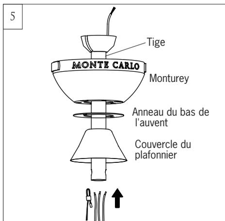
Mettez la tige de suspension sur l'auvent, l'anneau du bas de l'auvent et le couvercle de l'arcade. Enfilez les fils et le câble de sécurité de l'assemblage du moteur à travers la tige de suspension.
