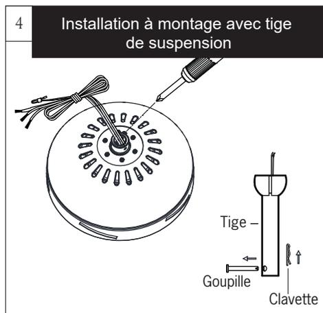
Desserrez légèrement les vis d'arrêt de la tige de suspension, du plafonnier se trouvant sur le dessus du boîtier du moteur. Enlevez la goupille et la clavette se trouvant sur la tige de suspension.
