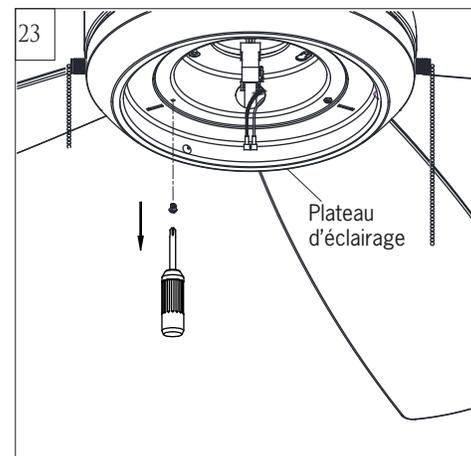
Desserrez 2 vis et retirez 1 vis préassemblée du luminaire. Conservez la vis pour utilisation ultérieure.
