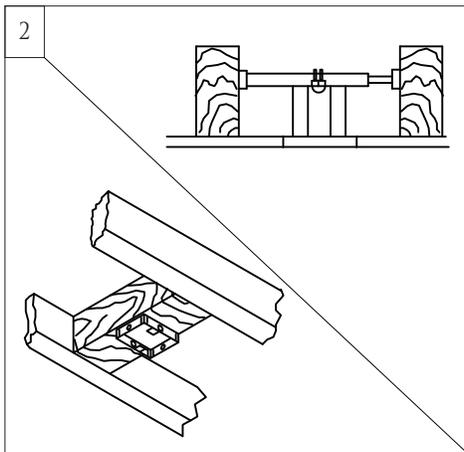
Avant d'installer ce ventilateur, vérifiez que la boîte de sortie de courant est bien connectée à la charpente du bâtiment. Pour éviter les risques d'incendie, d'électrocution ou d'accident, montez le ventilateur uniquement à une boîte de sortie de courant ou à un système de support pouvant supporter le poids du ventilateur. (L'ensemble de montage doit pouvoir supporter au moins 35lbs.(15.9 kg.))
