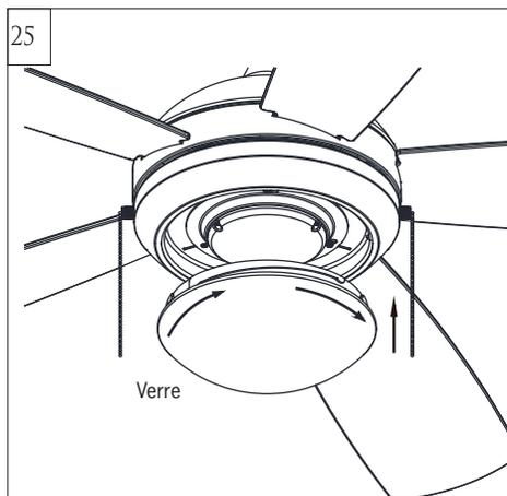
Fixez le verre au plateau d'éclairage en localisant les encoches du plateau d'éclairage avec les fentes du verre, puis tournez dans le sens des aiguilles d'une montre jusqu'à ce que les deux éléments soient verrouillés.
