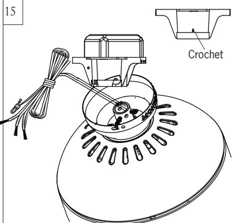
Pour préparer le ventilateur pour le câblage, suspendez le ventilateur sur le support de montage en glissant l'auvent sur le crochet du support de montage (**utilisez un des trous sans fente sur le bord de l'auvent**).
