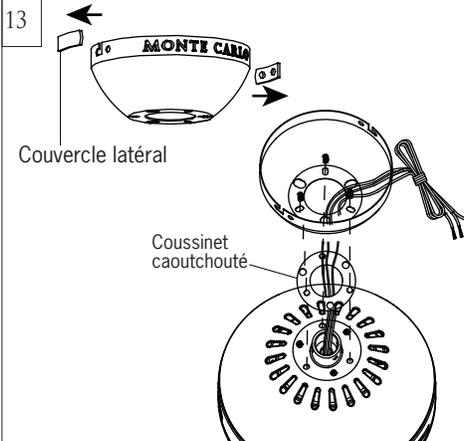
Retirez les couvercles latéraux de l'auvent pour montrer les 4 trous : 2 trous fermés et 2 trous ouverts en forme de L. Placez l'auvent et le coussinet caoutchouté sur le fil et le câble de sécurité et alignez les plus gros trous dans l'auvent et les trous sur le coussinet caoutchouté avec les vis de l'ensemble sur l'arcade.
