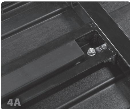
Posez la barre d'attelage de façon que le bord biseauté soit orienté vers le bas et l'arrière de la remorque. Fixez là à l'aide d'un boulon à tête hexagonale M12 x 85mm, 4 rondelles M12, et un contreécrou M12.
