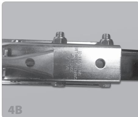
Sécurisez la tête d'attelage en place avec deux boulons à tête hexagonale M12 x 85mm et deux contreécrous M12.
