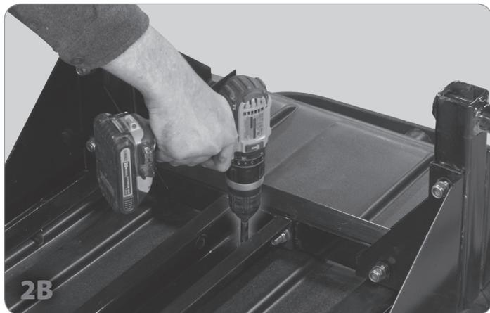
**NOTE:** Assurez-vous que le cadre est correctement aligné sur le corps avant de percer.
