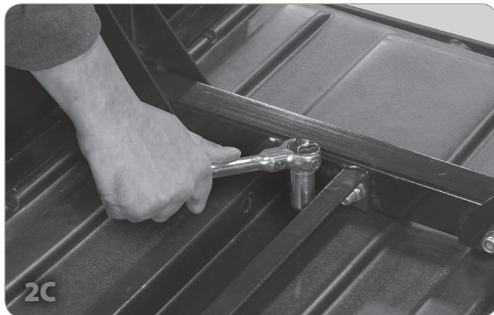
À l'extérieur de la carrosserie/tubulure en U, placez une rondelle M10 sur le boulon et le fixer avec un contreécrou.
