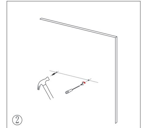
Insérez l'ancrage et la vis de montage dans le mur.
