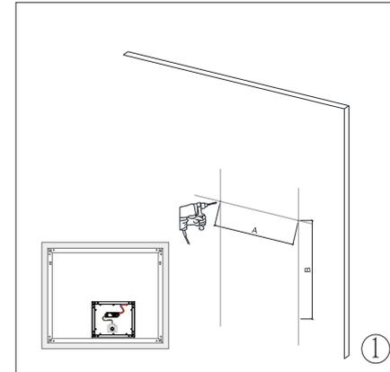
Mesurez la distance du trou de montage, percez des trous avec une perceuse de taille appropriée.
