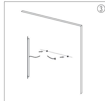
Connectez les fils du miroir avec vos fils principaux et accrochez le trou de montage à la vis sur le mur.
