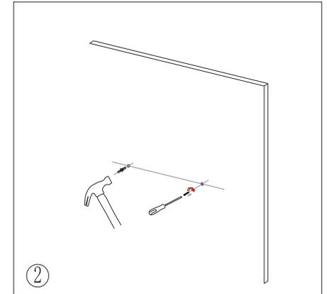
Insérez l'ancre et la vis de montage dans le mur.
