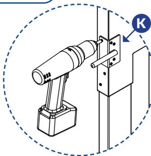
**1.** Fixez la pêne de verrou (K) à la ferrure supérieure avec (6) vis auto-foreuses en acier inoxydable noires de 1¼" (32 mm)
