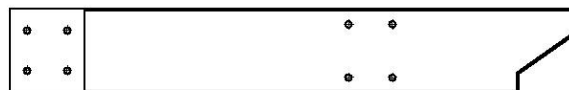
D3 | EXTRÉMITÉ DE SOLIVE - W4L16190 (x1) | 1 7/16 po x 5 1/4 po x 35 13/16 po (36 x 134 x 910)
