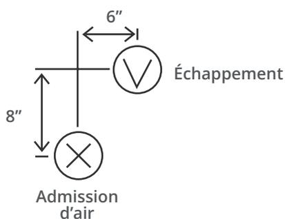
Les points de terminaisons des conduits d'échappement et d'admission d'air doivent être situés dans la même zone de pression et pointer dans la même direction.
