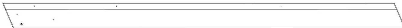
GP2 PANNEAU DE PIGNON - W2A03380 (x2) 2 13/16 po x 5 1/4 po x 80 3/16 po (72x134x2037)
