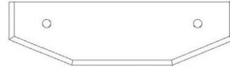
D05 PLANCHE DE RIVE DU PIGNON - W4L16753 (x2) 1 3/8 po x 1 1/2 po x 5 1/4 po (36x38x134)
