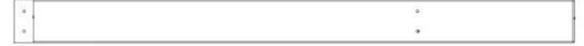
H08 PLANCHE DE REVÊTEMENT - W4L16395 (x2) 1 po x 3 3/8 po x 44 1/4 po (24x86x1124)
