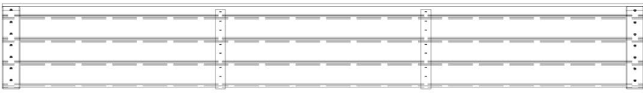
RP01 | PANNEAU DE TOIT - W2A02182 (x1) | 1/16"x1/16"x1/16" (40x287x2165)
