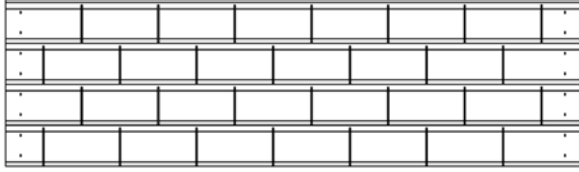
RP1 | PANNEAU INFÉRIEUR DE TOIT - W2A03166 (x2) | 1 3/8 "x13" x44 7/8 "(35x329x1140)
