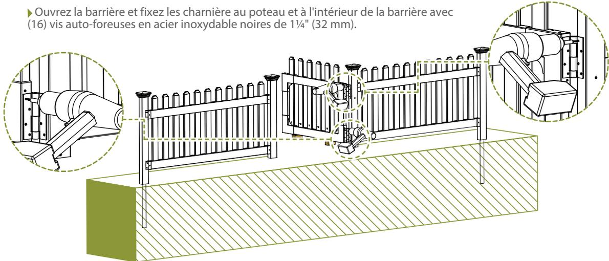
**Note:** Si votre pipe d'ancrage interne se rapproche du coin interne du poteau, vous aurez besoin de pré-percer les trous pour les vis auto-foreuses en acier inoxydable noires de 1/4" (32 mm), pour les permettre de pénétrer la pipe d'ancrage.
