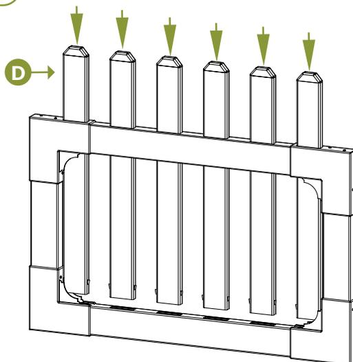
► Insérez piquets **(D)** à travers les trous de la barre supérieure et dans ceux de la barre inférieure.
