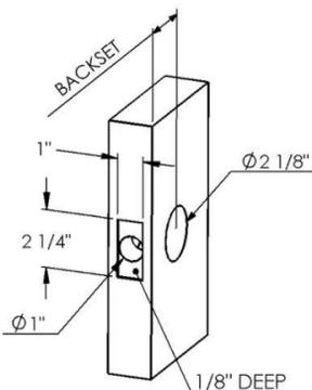
Préparation de la porte: La préparation de la porte est un ensemble de trous percés dans la porte, où le loquet et les leviers s'inséreront. 2 1/8" est une taille standard pour un trou percé à travers la porte. La plaque frontale du loquet est livrée avec des coins carrés mesurant 1" de large par 2 1/4" de haut et 1/8" de profondeur
