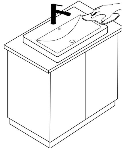
Poussez l'évier vers le bas et assurez-vous qu'il est stable et ne bascule pas sur le comptoir. Essuyez l'excédent de calfeutrage au silicone avec un chiffon humide. Raccordez le drain et l'alimentation en eau selon les instructions du fabricant.
