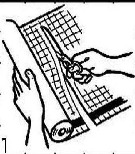
1. Mesurez, coupez pour ajuster (pour des extrémités de bord précises, ajoutez 3~4 mm et coupez les matériaux qui se chevauchent avec un couteau de coupe.)
