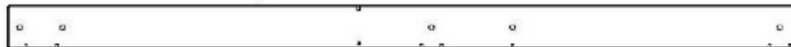
E2 | MONTANT AVANT DROIT - W4L14926 (x1) | 1 3/8 po x 3 3/8 po x 62 3/8 po (36 x 86 x 1 584)
