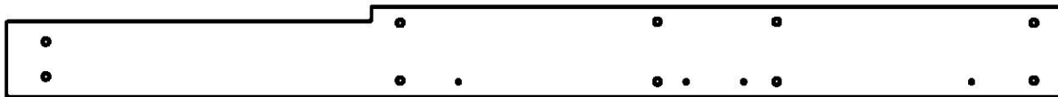
(1) G1 - SUPPORT DE POUTRE DE BALANÇOIRE - W4L11137 1 po x 5 1/4 po x 62 1/8 po (24x134x1577)
