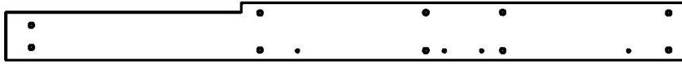
(1) G1 - SUPPORT DE POUTRE DE BALANÇOIRE - W4L11137 1 po x 5 1/4 po x 62 1/8 po (24x134x1577)
