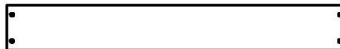
(7) M74 - PLANCHE DE MUR D'ESCALADE - W4L07624 5/8 po x 3 3/8 po x 25 po (16x86x635)
