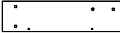
(1) K9 - LISSE MURALE GAUCHE DU BALCON - W4L11124 5/8 po x 5 1/4 po x 20 3/4 po (16x134x528)
