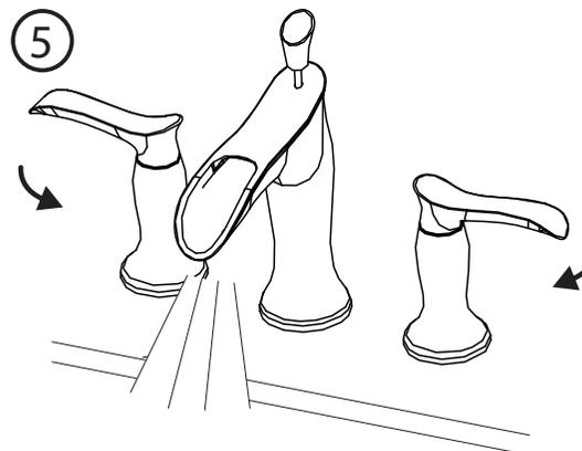
Ouvrir complètement la poignée du robinet; ouvrir les entrées d'eau chaude et d'eau froide, puis rincer les conduits d'eau pendant une minute. Installer de nouveau l'aérateur à la main.
