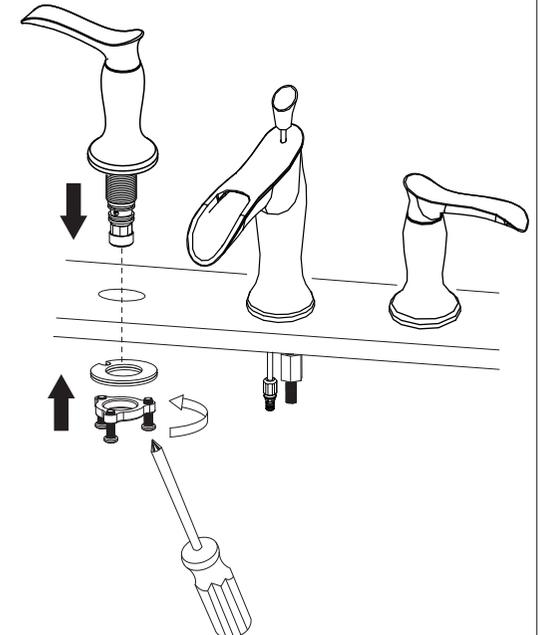
Placer la poignée sur la surface, comme illustré ci-contre. Fixer la poignée en place à l'aide de la trousse de montage et serrer la vis à l'aide d'un tournevis. Répéter les étapes susmentionnées pour l'autre poignée.
