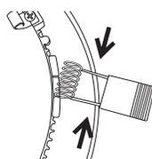
3) Fixer le culot de raccord à la base du 'Lightning Connector' dans la boîte de jonction en passant par l'entrée défonçable. Insérer le culot à vis dans la douille de lampe.
