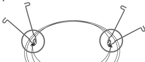
2) Retirez les attaches à ressort pinçant et en tournant.
