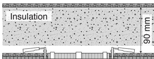
2) Découpez un trou à travers le plafond. Référez-vous au tableau plus bas pour les dimensions du trou à découper. Avant de commencer le découpage, assurez-vous que le trou n'empiétera pas sur des solives, de la tuyauterie, câbles ou autres équipements techniques du bâtiment.
