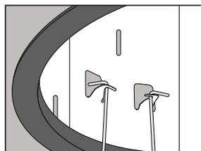
5) Poussez la garniture dans le luminaire jusqu'à ce qu'elle soit ajustée au plafond.
