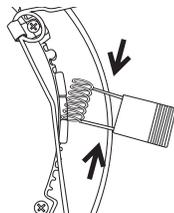
3) Fixer le culot de raccord à la base du 'Lightning Connector' dans la boîte de jonction en passant par l'entrée défonçable. Insérer le culot à vis dans la douille de lampe.
