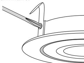
2) Retirez les attaches à ressort pinçant et en tournant.
