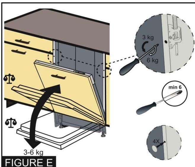
8- En fonction du poids de la porte en bois assemblée e, l'équilibrage doit être assuré par le mécanisme illustré à la figure E.
