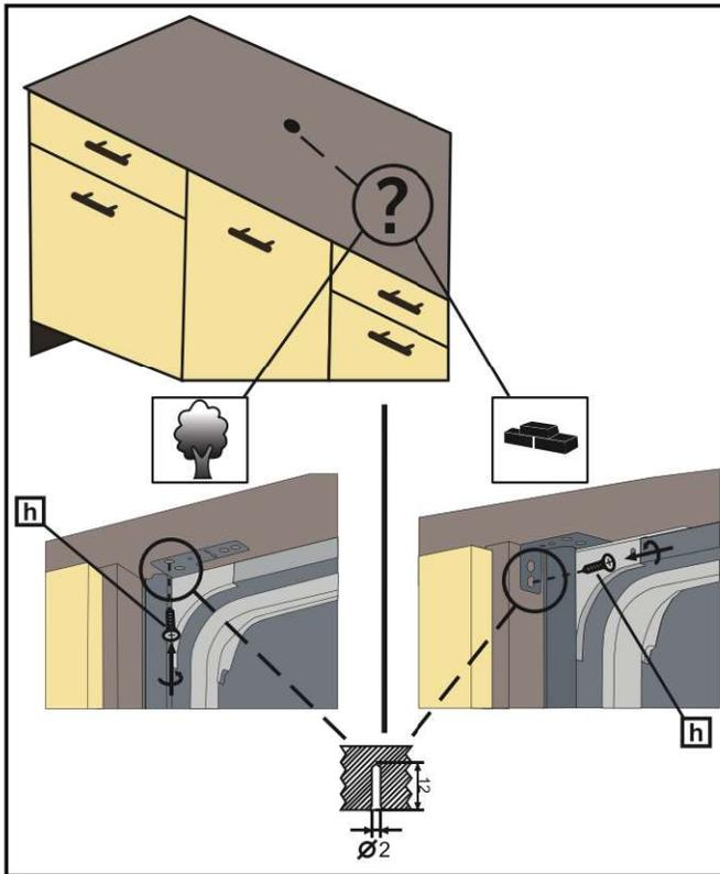
10- Les supports de fixation préalablement fixés au lave-vaisselle sont également fixés dans le meuble avec des vis de 5/32 po de diamètre x 19/32 po (4 mm de diamètre x 15 mm).
