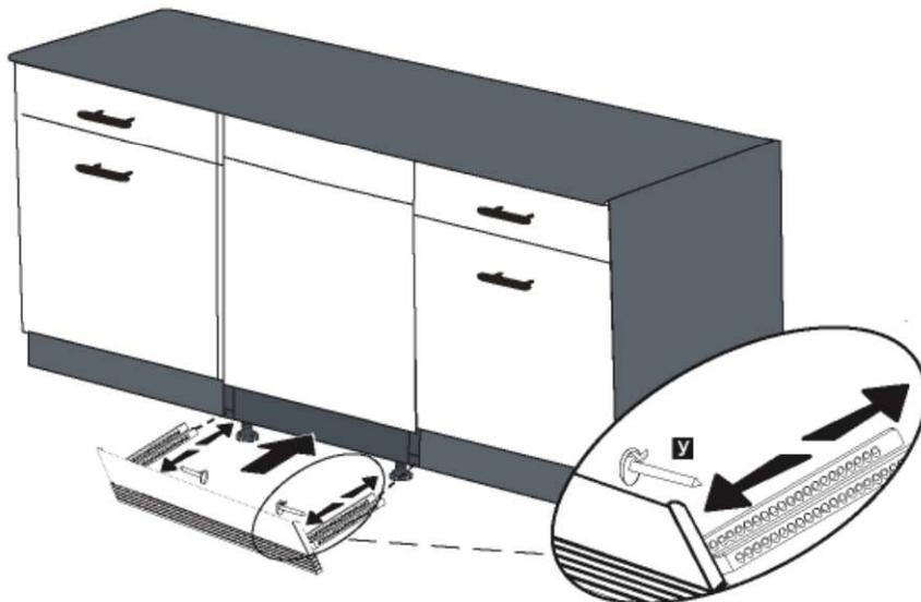
3. En fonction de la profondeur souhaitée, le système de verrouillage de la plinthe (y) est fixé sur le support de plaque de protection (o).
