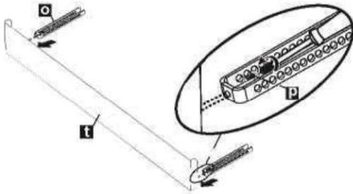
1. Si la hauteur est de 32 9/32 po à 34 9/32 po (820 mm-870 mm) et que vous utilisez des supports courts; installez un élément de réglage de plinthe métallique de 80 mm de longueur (v) et des supports de plaque de protection (o). Le montage se fait à l'aide de vis de 0 5/32 po x 7/32 po (4 mm x 6 mm) de diamètre avec un tournevis Philips.
