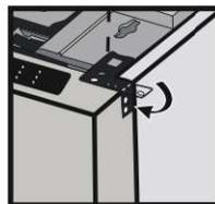
Si nécessaire (selon le matériau du comptoir), pliez les côtés des supports de fixation.
