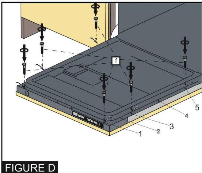
7- Comme le montre la figure D, Des vis de 5/32 po de diamètre x 53/32 po (4 mm de diamètre x 42.5 mm) sont installées en positions I, III et V.
