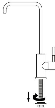
Retirez l'écrou de montage du robinet.
