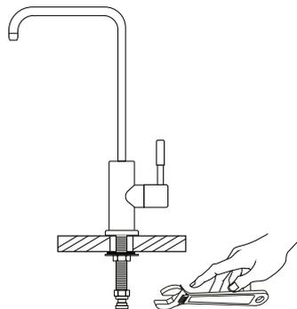
Serrez doucement le raccord avec une clé.
