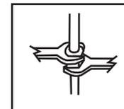
Serrez la connexion avec deux clés anglaises pour empêcher des dommages au corps du tuyau. Faites attention de ne pas plier la tige, puisque ceci annulera la garantie du produit.
