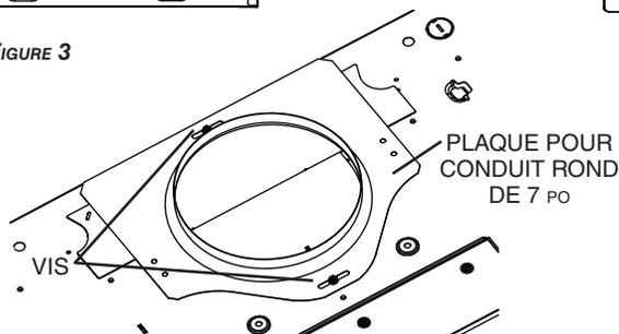
NOTE : La plaque pour conduit rond de 7 po peut être glissée latéralement, jusqu'à 1/2 po de chaque côté, pour s'ajuster à un conduit décentré.
