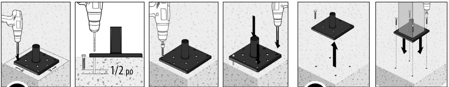
PERCEZ UN (1) TROU DANS UN COIN ET VISSEZ DANS L'ANCRAGE. PERCEZ LES TROIS AUTRES TROUS (3).
