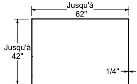
Toutes ces dimensions sont approximatives. Afin d'assurer une installation parfaite, les dimensions de la structure doivent être vérifiées à partir de l'unité.
