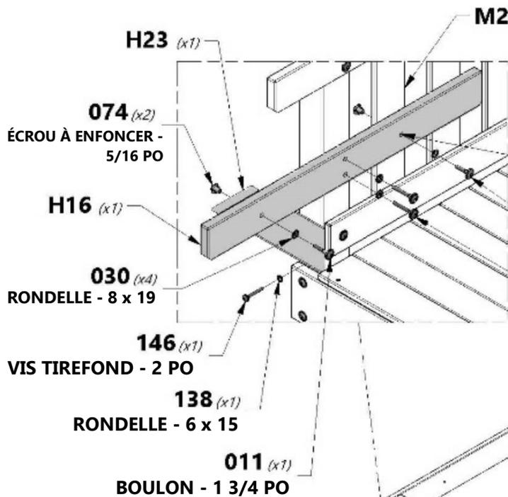
EN UTILISANT LA PIÈCE « H16 » COMME GUIDE, PERCEZ UN TROU DE 3/8 PO [10 MM] DE DIAMÈTRE DANS « M27 ».
