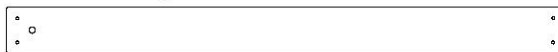
M14 | PLANCHE DE MUR - W4L14584 (x1) | 5/8 po x 3 po x 36 1/2 po (16x76x926)
