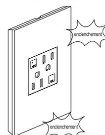
Enclencher la plaque murale au boîtier. Il existe trois crans pour régler la position de la plaque murale sur la sortie et le mur.
