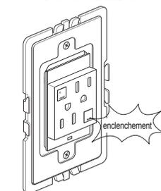
Repliez soigneusement les fils dans le boîtier, en tenant le fil de garde éloigné des bornes neutre et active. Enclenchez la sortie dans le cadre.
