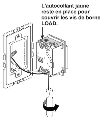
L'autocollant jaune reste en place pour couvrir les vis de borne LOAD.
