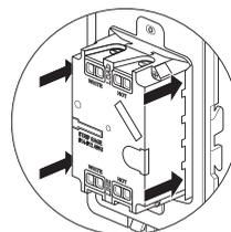
**REMARQUE** - Si vous avez besoin de retirer la sortie après l'avoir enclenchée dans le cadre, ôtez d'abord le cadre du boîtier mural pour accéder aux quatre ergots de verrouillage au dos de la sortie. Insérez un tournevis plat pour enfoncer les ergots en appliquant une pression afin de dégager la sortie.
