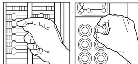
Ensuite, branchez et allumez la lampe ou la radio sur l'autre sortie de la prise pour vous assurer que l'alimentation est coupée aux deux sorties. Si l'alimentation n'est pas coupée, interrompez le travail et contactez un électricien pour compléter l'installation.
