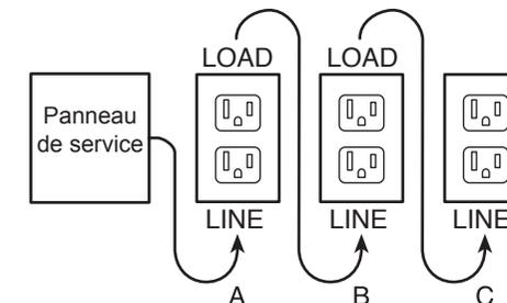
Placer le DDFT en position A garantira aussi la protection des sorties B et C « côté charge ». À l'inverse, placer le DDFT en position C ne garantira pas la protection aux sorties A et B. Retenez que les sorties A, B et C peuvent se trouver dans des pièces différentes.
