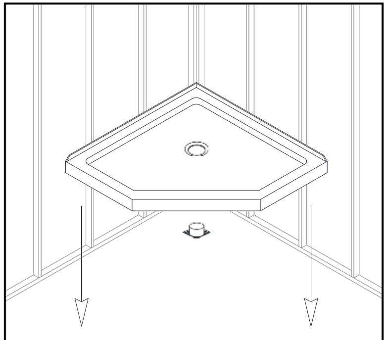
Abaissez la base par-dessus le tuyau de drainage et mettez-la en place contre les montants.
