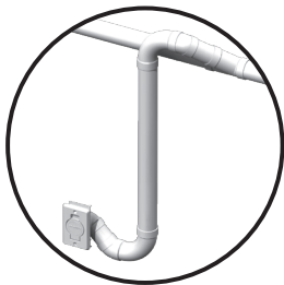
Au sous-sol (connecté en dessous d'une ligne sous le plancher)
