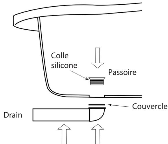
14. Insérez le tuyau dans le trou en utilisant l'anneau en O, la noix d'assemblage et la bride. Le tuyau devra peut-être être coupé. 1 ou 2" du tuyau devrait entrer dans le trou. Placez la bride sur le tuyau et placez le tout au sol.
