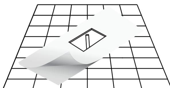
3. Déterminer l'emplacement du drain au sol en mesurant la distance entre le drain et le trou d'évacuation sous la baignoire. Nettoyer la zone de drain avant l'installation. La zone devrait être sèche et vide.
