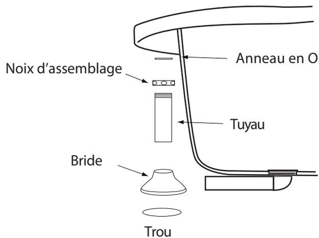
15. Assemblez la section tee avec le tuyau, bague anti débordement, et le drain en utilisant des noix d'assemblage et des anneaux en O.
