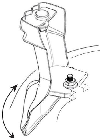
12. Serrez la noix #3 avec une clé à molette et ajuster le pied si nécessaire. Recommencer pour les trois autres pieds.
