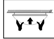
3. Installer le nouveau diffuseur en le tournant jusqu'il soit solidement fixé. Assurez-vous que le diffuseur est installé adéquatement pourrrait tomber.
