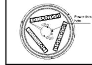
2. Choisissez le bon fil (0.75-1.5mm<sup>2</sup>) et connectez le fil correctement, sinon, il provoquera facilement le feu et d'autres accidents.
