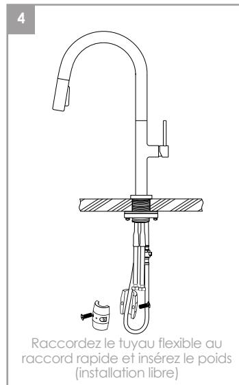
Raccordez le tuyau flexible au raccord rapide et insérez le poids (installation libre)
