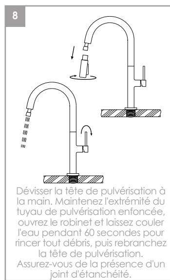
Dévisser la tête de pulvérisation à la main. Maintenez l'extrémité du tuyau de pulvérisation enfoncée, ouvrez le robinet et laissez couler l'eau pendant 60 secondes pour rincer tout débris, puis rebranchez la tête de pulvérisation. Assurez-vous de la présence d'un joint d'étanchéité.
