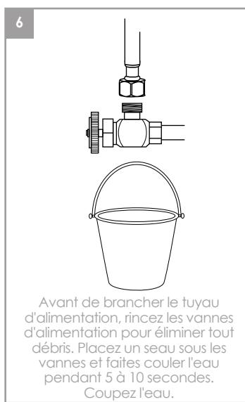
Avant de brancher le tuyau d'alimentation, rincez les vannes d'alimentation pour éliminer tout débris. Placez un seau sous les vannes et faites couler l'eau pendant 5 à 10 secondes. Coupez l'eau.
