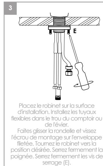
Placez le robinet sur la surface d'installation. Installez les tuyaux flexibles dans le trou du comptoir ou de l'évier.
