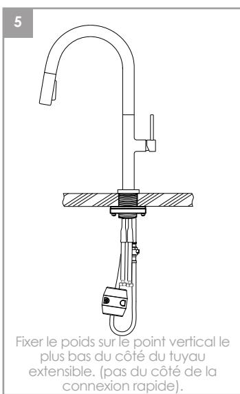
Fixer le poids sur le point vertical le plus bas du côté du tuyau extensible. (pas du côté de la connexion rapide).
