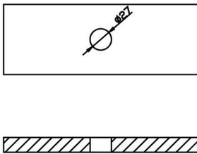
La taille recommandée du diamètre du trou va de 25 mm à 29 mm.
