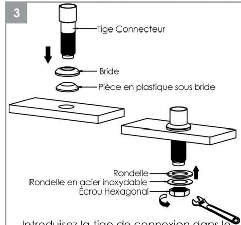
Introduisez la tige de connexion dans le trou, assurez-vous que la bride et le caoutchouc plastique se trouvent au-dessus du comptoir. Fixez la tige de connexion avec un écrou hexagonal, et serrez fermement avec une clé.
