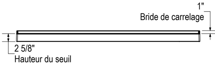
Toutes ces dimensions sont approximatives. Afin d'assurer une installation parfaite, les dimensions de la structure doivent être vérifiées à partir de l'unité.
