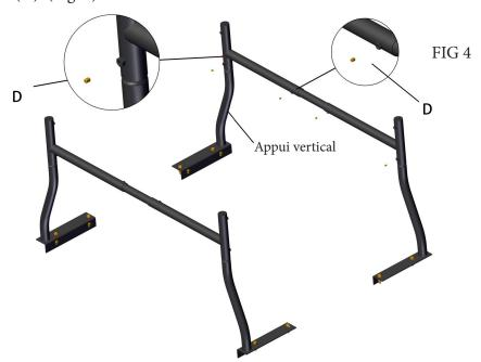
5. Placez la partie avant des appuis verticaux, aussi près que possible de la cabine. Fixez les plaques de montage au rail de la caisse de la camionnette, en perçant des trous de 11 mm (7/16 po) dans le rail de caisse et la lèvre. Par la suite, fixez la plaque de montage avec deux jeux de boulons hexagonaux (A), de rondelles plates (B) et d'écrous de blocage M10 (C), à travers la partie supérieure et la partie latérale de la plaque de montage. (Fig. 5)
