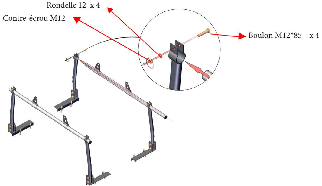
4. Installez la barre transversale assemblée sur les ouvertures supérieures de chaque poteau (3) et resserrez à l'aide de boulons 12\*55 (19), de rondelles 12 (6) et de contre-écrous M12 (20).
