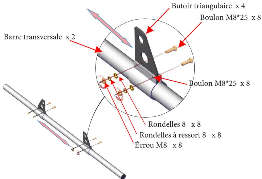
1. Introduisez 2 manchons de montage (14) sur une des barres transversales (4). Insérez un butoir triangulaire (13) dans le manchon de montage (14) et fixez en place à l'aide de boulons M8\*25 (15) et de rondelles 8 (16), de rondelles à ressort 8 (17) et d'écrous M8 (18). Répétez pour les 4 butoirs triangulaires
