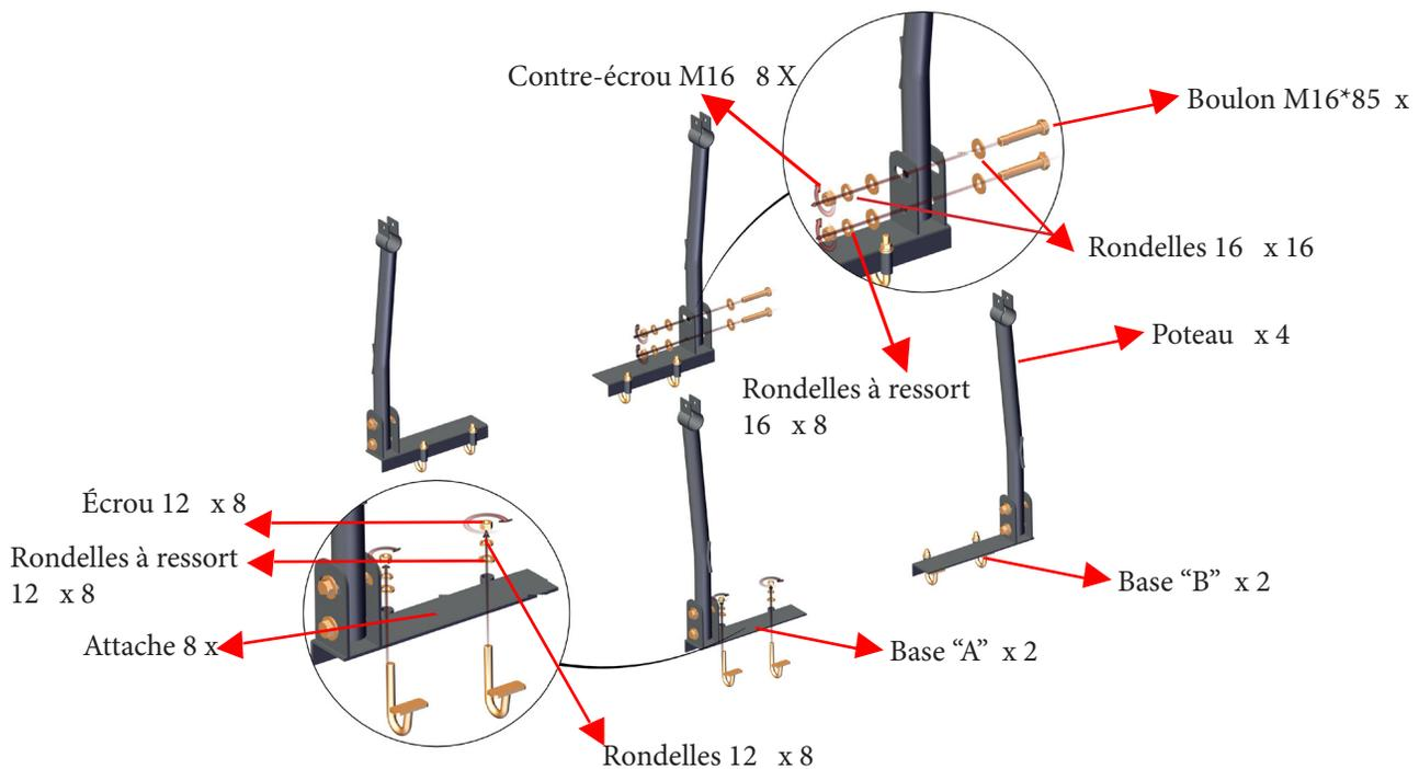
2. Saisissez la partie inférieure du poteau (3) et alignez les orifices du poteau (3) aux orifices des bases (1 et 2). Fixez en place à l'aide de boulons M16\*85 (9), de rondelles 16 (10), de rondelles à ressort 16 (11) et de contre-écrous M16 (12). Répétez pour les 4 poteaux et bases.
