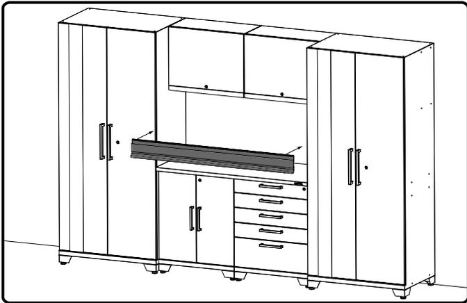
Pré-percez des trous de 3 mm (1/8 po) dans chaque montant, puis fixez la section de panneau à chaque montants en bois à l'aide des vis fournies.
