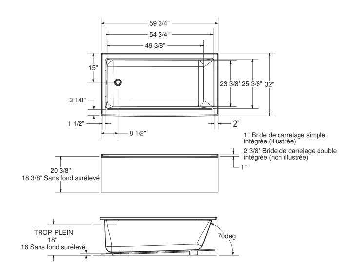
Le modèle du support de bois peut varier. Bride de carrelage simple intégrée: 1" hauteur x 1/4" épaisseur ( illustrée) Bride de carrelage double intégrée: 2 3/8" hauteur (non illustrée)
