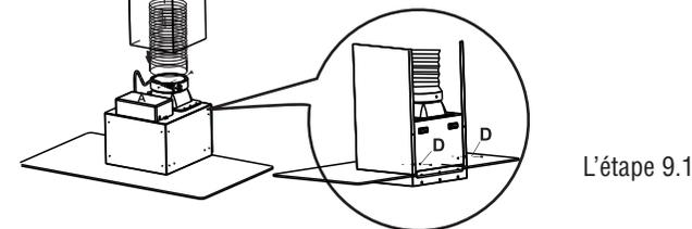
Pour les modèles S-100, S-101, S-120, S121, S-140 : Insérez le couvre cheminée (H) entre la partie principale de la hotte et la plaque en acier lisse. Le couvre cheminée n'a pas besoin d'être fixé.
