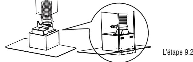
10. Posez l'extension de cheminée (G) dans le couvre cheminée (H). La partie avec la grille devrait aller en haut. Pour les modèles S-100, S-101, S-120, S121, S-140 : Insérez le couvre cheminée (H) entre la partie principale de la hotte et la plaque en acier lisse. Le couvre cheminée n'a pas besoin d'être fixé.
