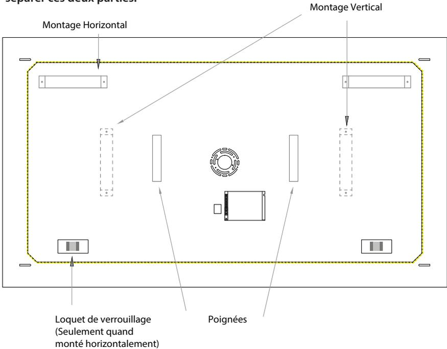
2. Retirez les deux supports horizontaux à l'arrière du cadre. Alignez les trous sur le support avec les trous placés pour le montage vertical et vissez le support. Retirez les deux loquets de verrouillage situés au bas du cadre métallique en enlevant sa vis.
