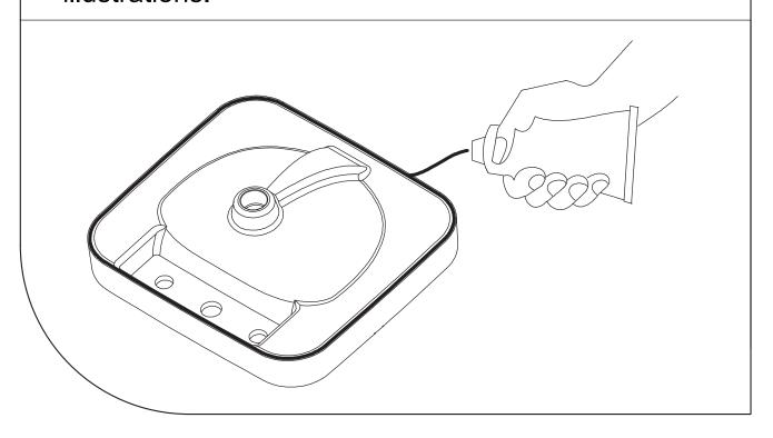
Installez avec précaution le lavabo sur le plan de tra Appuyez légèrement sur le lavabo pour mettre e l'adhésif d'étanchéité.
